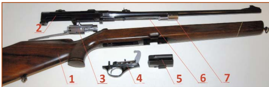
Основные части карабина МЦ 125. Калибр .308 Win. 1 – ложа с основанием коробки, 2 – ствол с коробкой, 3 – затвор, 4 – УСМ, 5 – магазин, 6 – шток газового движка, 7 – газовая камера
