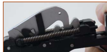
Ударно – спусковой механизм карабина МЦ 125. 8 – корпус УСМ, 11 – перехватыватель, 19 – рычаг перехватывателя, 4 – курок, 10 – предохранитель, 9 – спусковой крючок, 14 – шептало, 6 – разобщитель
