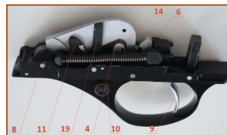
Ударно – спусковой механизм карабина МЦ 125. 8 – корпус УСМ, 11 – перехватыватель, 19 – рычаг перехватывателя, 4 – курок, 10 – предохранитель, 9 – спусковой крючок, 14 – шептало, 6 – разобщитель
